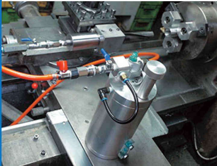
図1 オイルミスト噴射装置「クールミスター」
